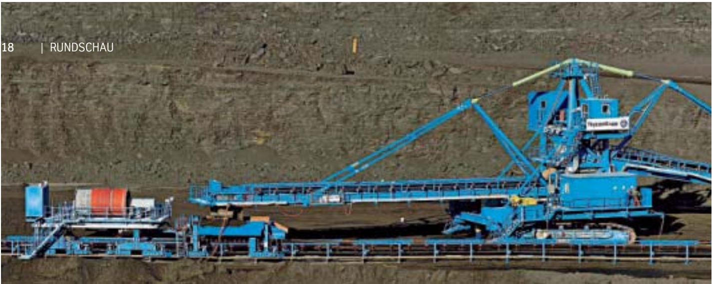
Gigant | Trotz der enormen Größe, ist die Brechanlage flexibel und mobil. Fotos: ThyssenKrupp Fördertechnik
